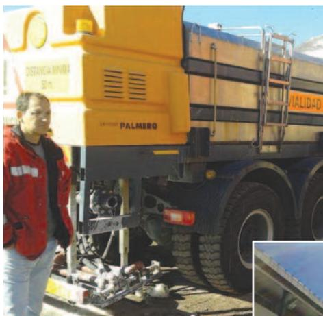
*Centre d'exploitation de Puente del Inca, le principe c'est bien sûr d'évacuer la neige, mais de plus en plus on s'intéresse au précuratif neige pour éviter le collage avec une épandeuse à saumure dont le constructeur est italien.*
