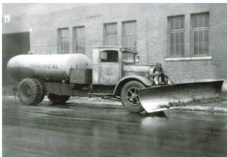
Saumureuse à Montréal (photo Cete de l'Est)
