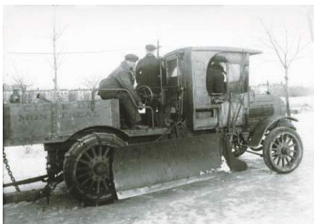
Lame biaise installée sur un camion (photo Cete de l'Est)
