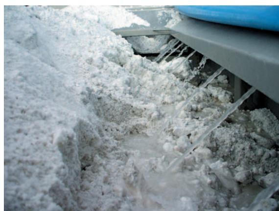
**Injection de l'eau en partie supérieure pour dissolution de la fine de sel**
